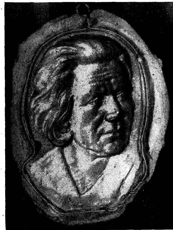
34. Гипсовая форма с проложенным проводником и петлей-подвеской
